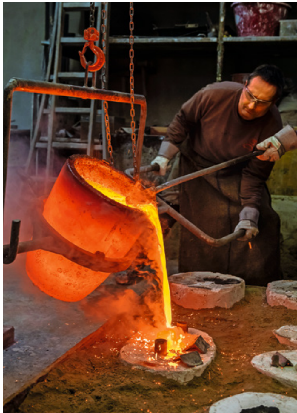
1100 Grad Richard Bründler giesst die flüssige Bronze in die Hohlräume.
