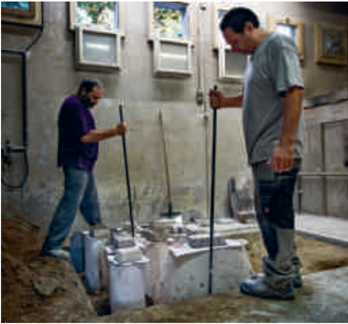
Oben: Der gestampfte Sand, in den die Gussformen eingebettet werden, bewahrt sie beim Giessen vor dem Zerspringen.
